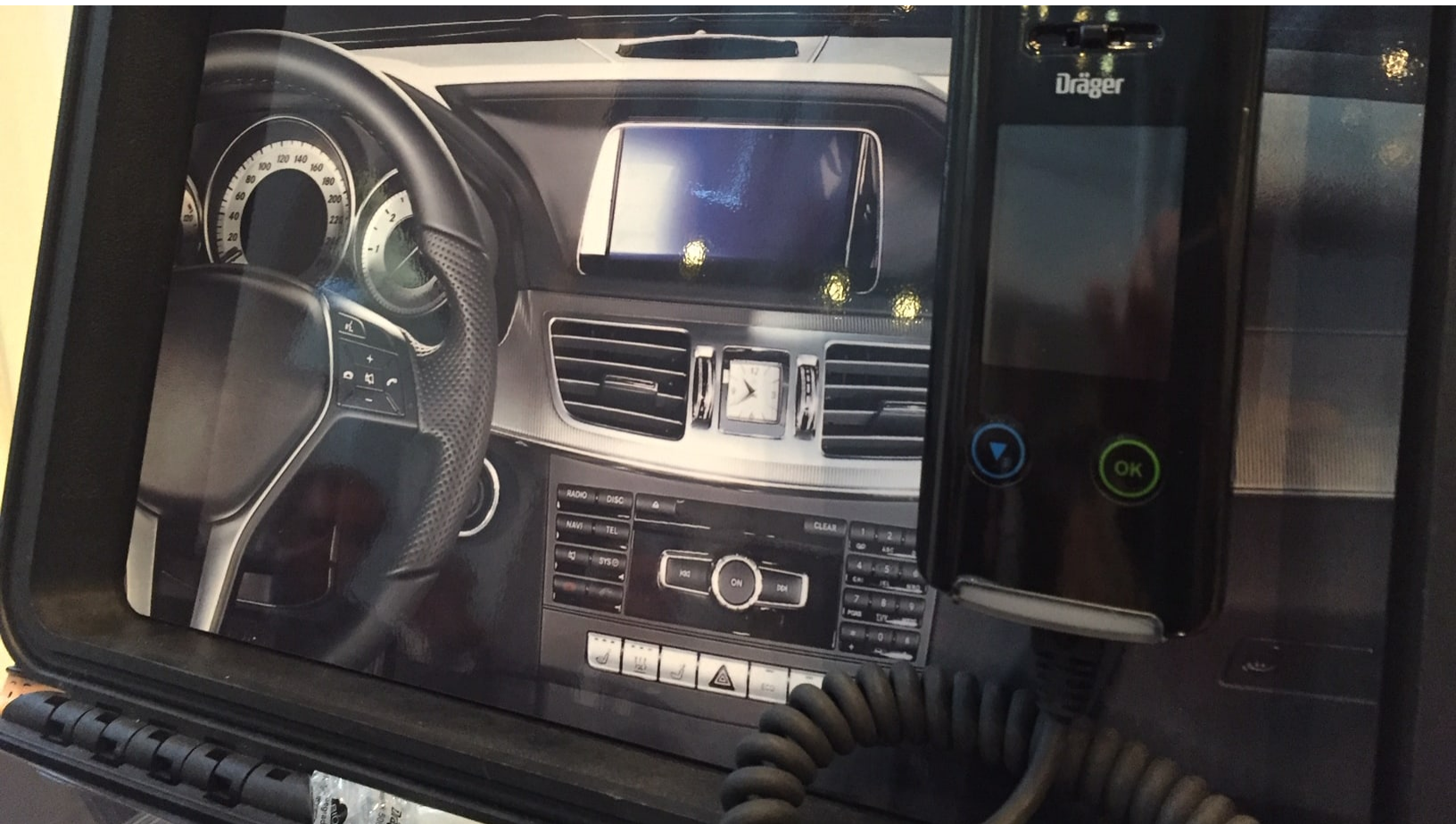
Installiertes Alkohol-Interlock Gerät
